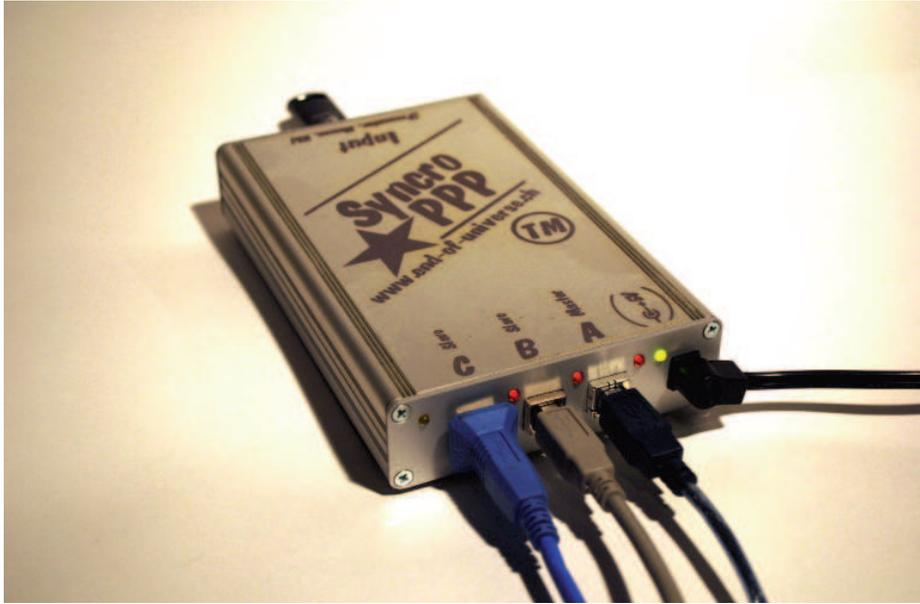
Wird eine externe Spannungsversorgung angeschlossen, so leuchtet die Spannungsanzeige grün.
