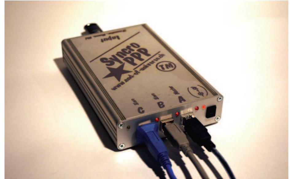
Weitere Laptops/PCs werden an Buchse „B“ und / oder „C“ angeschlossen. Auch hier leuchtet die jeweilige Leuchtdiode rechts von der Buchse rot, wenn die USB-Verbindung aktiv ist. Werden nur 2 Laptops/PCs angesteuert, so kann nebst „A“ beliebig an Buchse „B“ oder „C“ angeschlossen werden.
